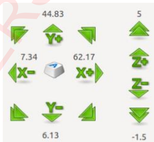
Figura 2. Detalle del control manual de coordenadas desde EHU_CNC.
