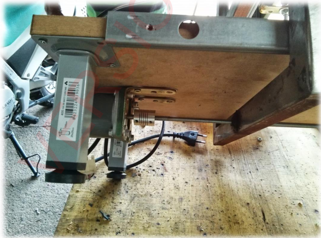
Figura 35. Detalle de la unión varilla-eje acoplado.
