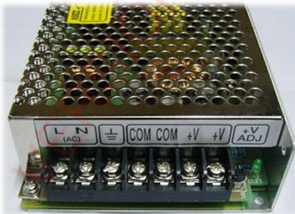
Figura 12. Detalle de las conexiones de la fuente de alimentación.
