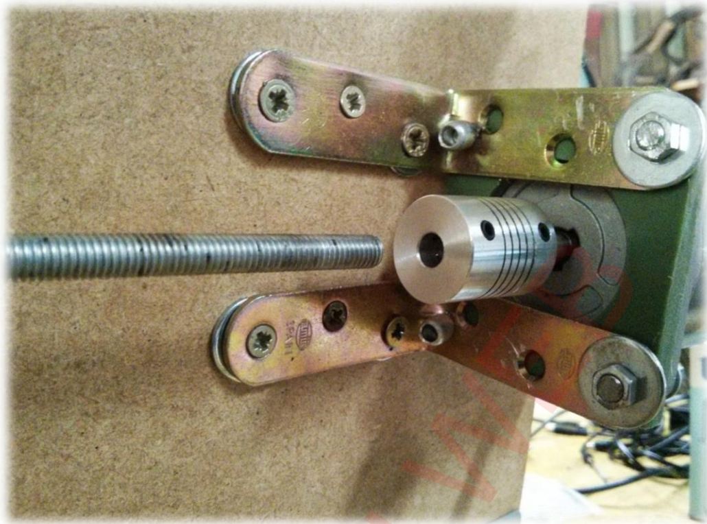
Figura 34. Detalle de la unión varilla-eje sin acoplar.
