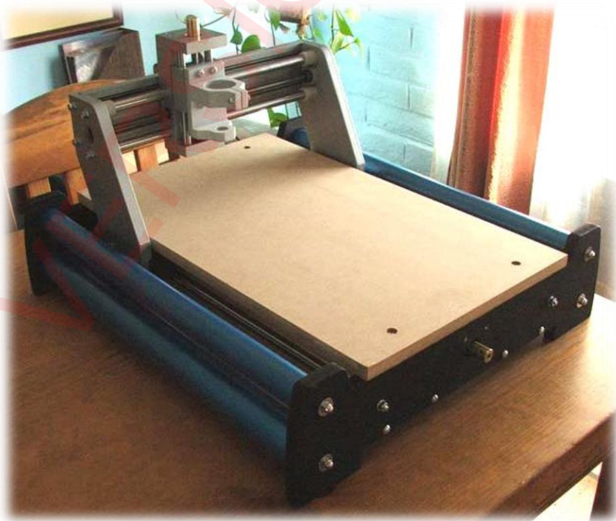
Figura 1. Máquina controlada con Linuxcnc. (www.britishideas.com)
