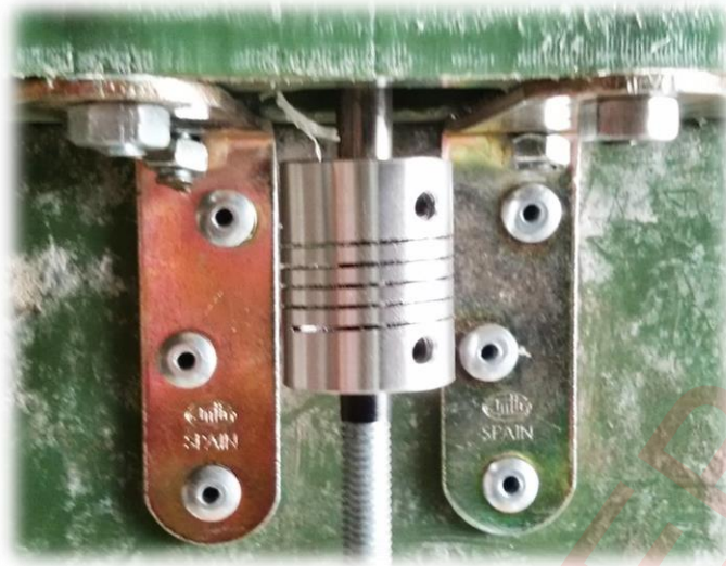
Figura 16. Detalle de la unión varilla-eje.
