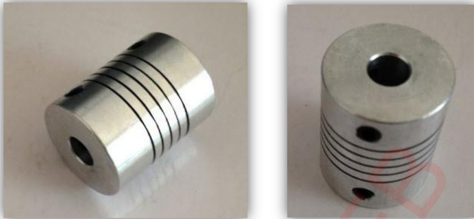
Figura 32. Detalle de los acoples Eje-Motor.
