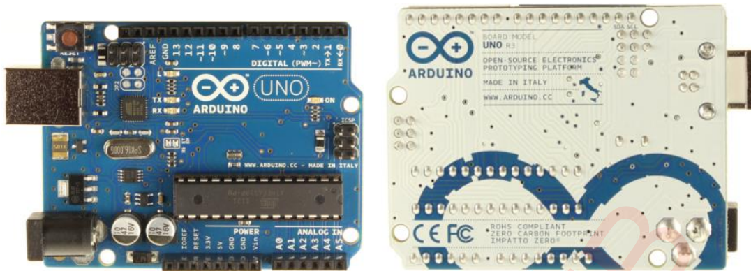
Figura 38. Vista frontal y posterior de Arduino Uno R3.
